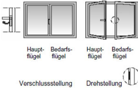
Hauptflügel mit Drehkipp- und Bedarfsflügel mit Drehöffnung
