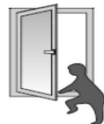
Zum Schutz von Personen ist der Flügel gegen Aufdrehen zu sichern, z. B. mit Dreh Sperre oder abschließbarem Bedienunggriff.
